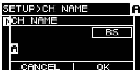
在字符输入模式下，转动主旋钮选择需要输入字符的位置，然后按下主旋钮确认。转动主旋钮选择需要输入的字符，然后按下主旋钮确认字符。
