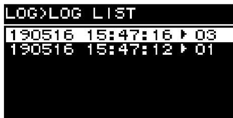
转动主旋钮选择一个事件，然后按下主旋钮进入DETAIL VIEW画面。
