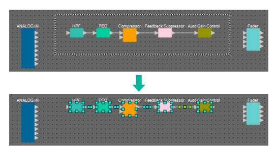
4. 复制所选组件和电线并粘贴两次,或者在按住 <Ctrl> 的同时拖放所选组件和电线。 根据需要更改组件的布局。
