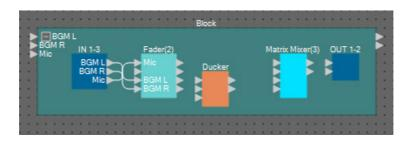
23. 拖放 "Fader(2)" 输出端口 1, 将其连接到 "Ducker" KeyIN 和 "Matrix Mixer(3)" 输入端口 1; 拖 放 "Fader(2)" 输出端口 3 和 4,将其连接到输入 "Ducker" 端口 1 和 2。
