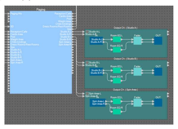
9. 拖放各用户定义模块的输出端口,将其连接到 "ANALOG OUT" 输入端口 1 至 6。
