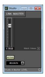
6. 在按住<Ctrl>的同时,将练习室A主LEVEL的Link Master编辑器的推子拖放到"Settings"对话框 的 "PARAMETER" 区域中。
