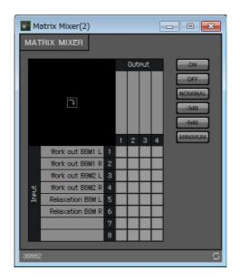
4。进行设置,使输入1和2发送到输出1,使输入3和4发送到输出2,使输入5和6发送到输出3。
