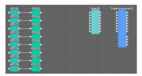
5. 通过拖放操作,连接 "ANALOG IN" 1 至 8 端口和各 "HPF" 输入端口。
