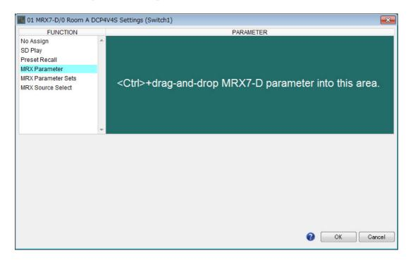
7。在按住<Ctrl>的同时,将组合器参数设置窗口中房间1的麦克风[ON]按钮拖放到"Settings"对话框 中的 "PARAMETER" 区域。
