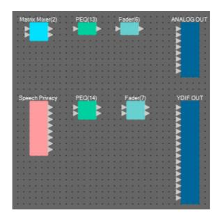
2。在 "Dugan Automixer" 输出端口 a 和 "Matrix Mixer(2)" 输入端口 1 之间拖放进行连接。在 "Matrix Mixer" 输出端口 1 (编解码器输出)和 "Matrix Mixer(2)" 输入端口 2 之间拖放进行 连接。
