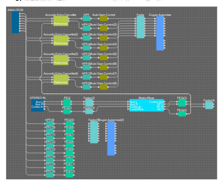
6. 在各 "PEQ" 输出端口和 "Fader" 输入端口之间拖放进行连接。
