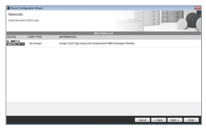
11. 选择将要连接到 MRX 的 DCP 型号,输入设备名称,并单击 [Finish]。 在此示例中,指定七个 DCP1V4S 装置。
