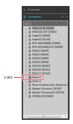
3。由于使用房间A的"Fader(2)"调节房间A的AUX电平,因此在"Parameters"区域中打开[Room A] → [Fader(2)]<sub>o</sub>
