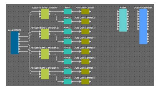
9. 在 "Auto Gain Control" 输出端口和 "Fader" 输入端口之间拖放进行连接。
