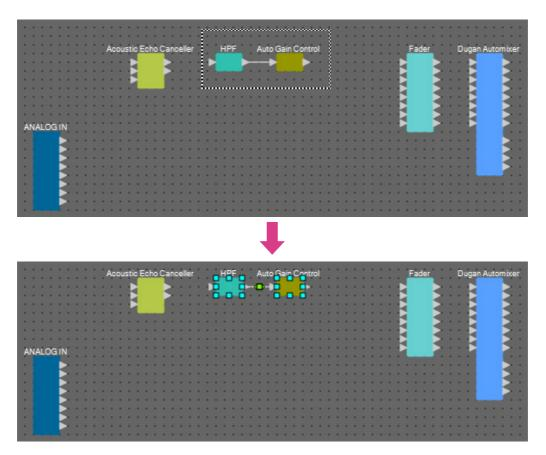
4. 复制所选组件和电线并粘贴一次,或者在按住 <Ctrl> 的同时拖放所选组件和电线。 根据需要更改组件的布局。
