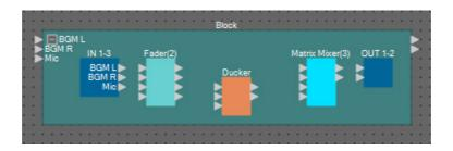
22. 拖放"IN"输出端口1和2,将其连接到"Fader(2)"输入端口3和4;拖放"IN"输出端口3,将其连 接到 "Fader(2)" 输入端口 1。
