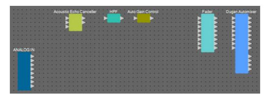
2. 拖放 "HPF" 和 "Auto Gain Control" 端口之间的组件进行连接。
