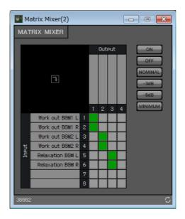
5。对输出1输入"Work out BGM1",对输出2输入"Work out BGM2",对输出3输入"Relaxation BGM", 然后单击右上角的 [x] 按钮关闭组件编辑器。
