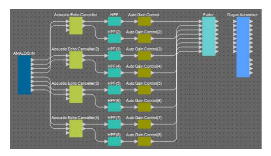
10。在 "Fader" 输出端口和 "Dugan Automixer" 输入端口之间拖放进行连接。
