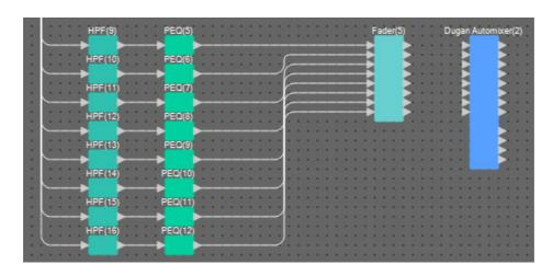
7. 在 "Fader(5)" 输出端口 1 至 8 和 "Dugan Automixer" 输入端口 1 至 8 之间拖放进行连接。
