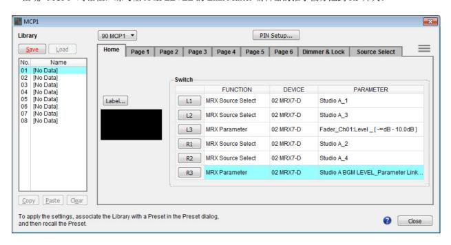
8. 若要创建将在 MCP1 的显示屏中显示的画面,请单击 [Label] 按钮。 出现 "Label" 对话框。
