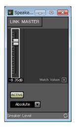
3。在按住 <Ctrl> 的同时,将 Link Master 编辑器推子拖放到 "Remote Control Setup List" 对话框 No.001 行中的 "PARAMETER" 区域。
