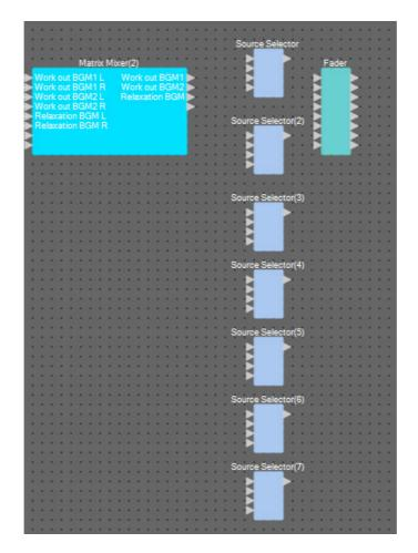
8. 拖放 "Matrix Mixer(2)" 输出端口 1 至 3,将其连接到 "Source Selector" 输入端口 1 至 3。
