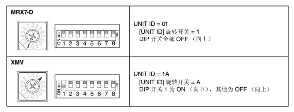
**5.** 完成设置 MRX 和 XMV 的 [UNIT ID] 旋转开关和 DIP 开关时,单击 [Next>]。
