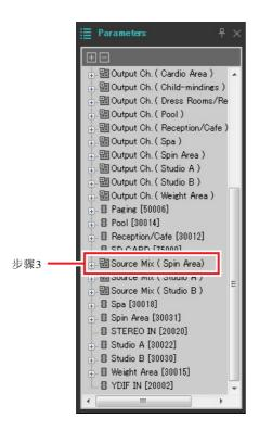
3。由于使用源混音 (动感单车区)的 "Fader(4)"调节动感单车区背景音乐的电平,因此打开 "Parameters" 区域 [Source Mix (Spin Area)] → [Fader(4)]。
