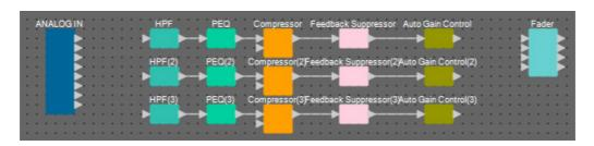
**5.** 将各 Auto Gain Control 连接到 Fader。
