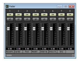
13. 关闭通道 8, 然后单击右上角的 [x] 按钮关闭组件编辑器。
