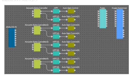
8。对各个"Acoustic Canceller"通过拖放操作,连接"ANALOG IN" 1至8端口和Mic In 1/2端口。
