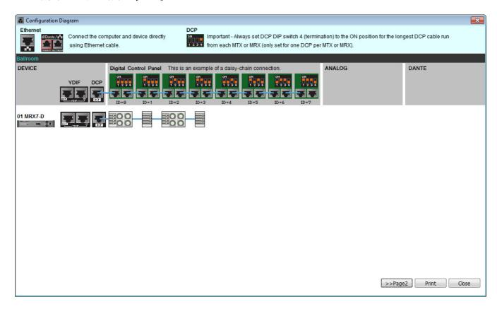
按照示意图的 "Digital Control Panel" 部分所示设置 DCP 组件的 DIP 开关。 对于最后的 DCP (ID=3),将 DIP 开关 4 设置为 ON (向上)。
