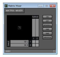
6. 进行设置, 使输入1和2输出到输出1, 对输出1输入"SD", 然后单击右上角的[x]按钮关闭组件 编辑器。
