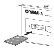
正确识别SD存储卡后,[SD/ACT]指示灯(第9页)将 亮起。读取存储卡时, [SD/ACT]指示灯将闪烁。
