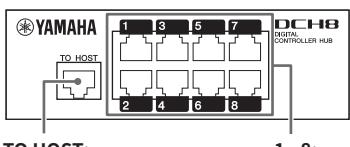
**TO HOST:** 将主机设备或 DCH8 的 [DCP] 接口连接到主机。
