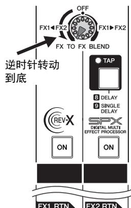
6. 打开 FX1 RTN 通道的 ON 开关, 然后将 FX1 RTN 推子推起, 调节效果深度。
