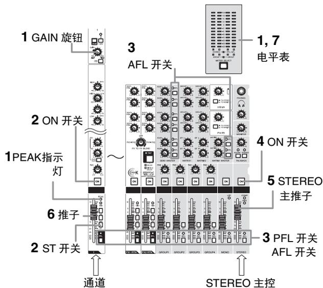
1. 在您的话筒或乐器发出声音的同时，调节通道 GAIN 旋钮，让相应的峰值指示灯在最高峰值电平时偶尔闪烁。
