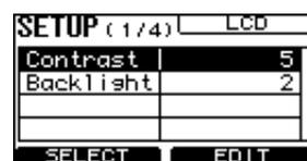
2. 转动旋钮 1 选择“Backlight”，然后转动旋钮 2 调节亮度。
