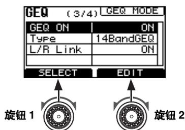
2. 转动旋钮 1 选择“GEQ ON”，然后转动旋钮 2 设定为“ON”。
