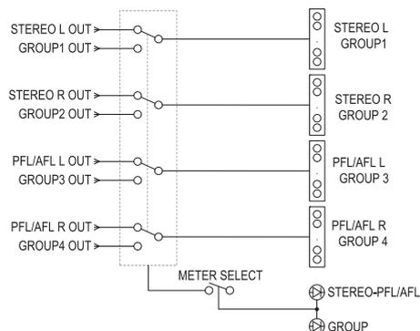
用这些电平表可以查看多种信号的电平：STEREO OUT L/R 插口的电平、PFL 和 AFL 电平、发送到 GROUP OUT 1-4 插口的信号的电平。用这些电平表显示的 PFL 或 AFL 信号，可以通过 MONITOR OUT 插口和 PHONES 插孔进行监听。
