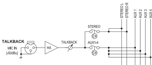
对讲功能主要用于调音师向乐手和工作人员发布指令。该部分可以调节从 TALKBACK MIC IN 插口接收到的话筒信号的电平，并决定要被输出到的总线。
