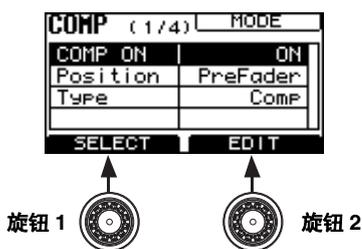
2. 转动旋钮 1 选择“COMP ON”, 然后转动旋钮 2 设定为“ON”。
