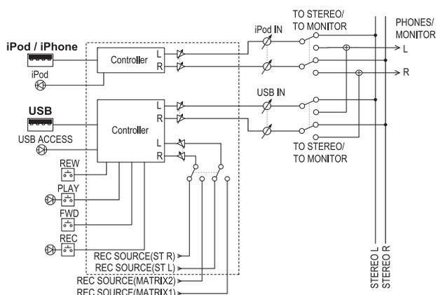
该部分可以决定从已连接的 USB 设备或 iPod/iPhone 输出的信号的发送目标位置，并调节信号的电平。
