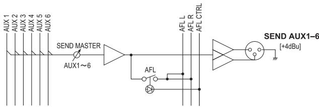
该部分用于调节和控制来自 6 个 AUX 总线的信号输出的电平。这些信号中的每一个都会输出到对应 SEND (AUX1-AUX6) 插口。
