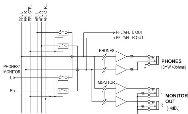
可以连接一副耳机并调节 PHONES 和 MONITOR OUT 插口的输出信号电平。
