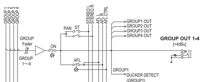
该部分用于调节和控制来自 4 个 GROUP 总线的信号流。来自每个 GROUP 总线的信号总是会发送到对应的 GROUP OUT 插口，与此同时，也可以用 ST 和 AFL 开关选择性地将这些编组发送到 STEREO 和 AFL 总线。
