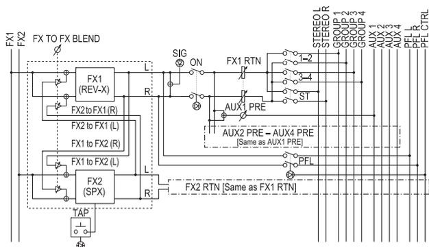
该部分可以设定效果 (FX1 和 FX2) 返回功能的打开 / 关闭状态, 还能决定 FX 的信号电平和将信号发送到哪根总线。
