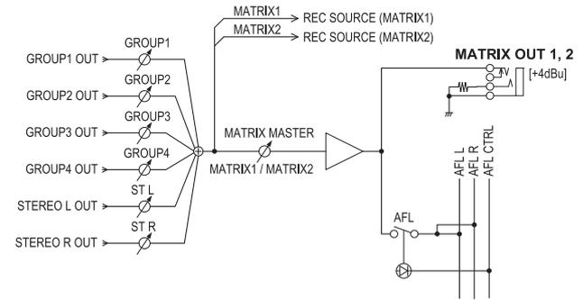
该部分用于调整、控制从 GROUP OUT 和 STEREO OUT 输出到 MATRIX OUT 插口的信号的整体电平。来自 MATRIX 1 和 2 总线的信号会被发送到对应的 MATRIX 1 和 2 插口。
