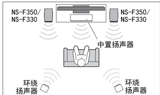
在电视的两侧放置扬声器。扬声器的定位非常重要，因为这决定了多通道系统的整体音质。遵循放大器附带的用户手册操作，以您的聆听位置为基础放置扬声器。
