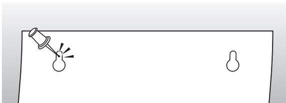
**2** 取下模板, 然后将市面出售的自攻钉 ( $\varnothing$  6 mm) 安装到标记的位置。
